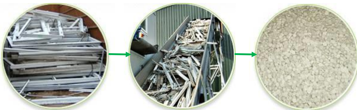
Slika 4.6. Dobijanje granulata od PVC prozora
