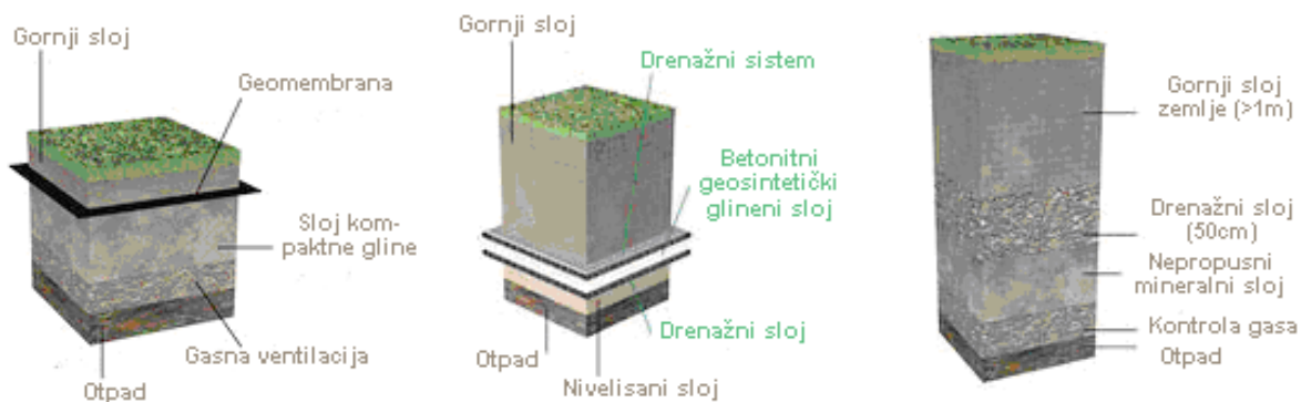
Slika 5.13. Prikaz gornjih pokrivnih slojeva deponije
