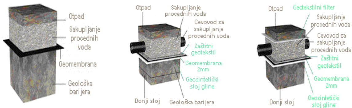
Slika 5.17. Prikaz donjih slojeva deponije
