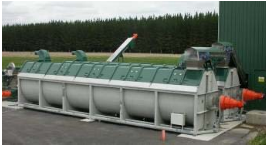
Слика 43 - Изглед хоризонталног реактора
