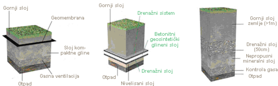
Слика 5.13: Приказ горњих покривних слојева депоније
