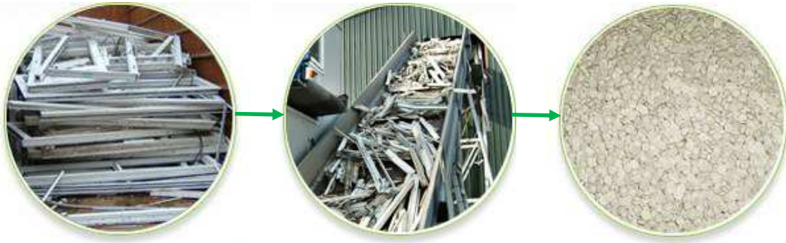
Слика 4.6: Добијање гранулата од ПВЦ прозора
