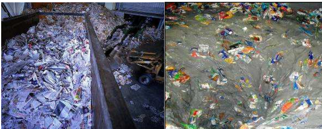
Слика 4.3: Пријем папира и процес његовог испирања
