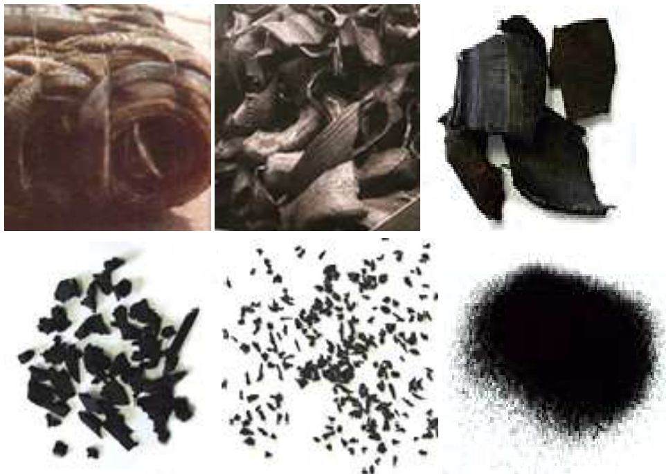
Слика 4.11: Уситњавање аутомобилских гума до најмање гранулације
