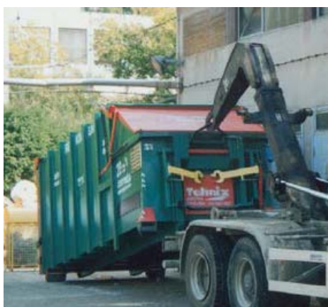
Слика 6.5. Пример транспорта прес или ролоконтејнера
