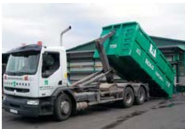
Слика 6.5. Пример транспорта прес или ролоконтејнера
