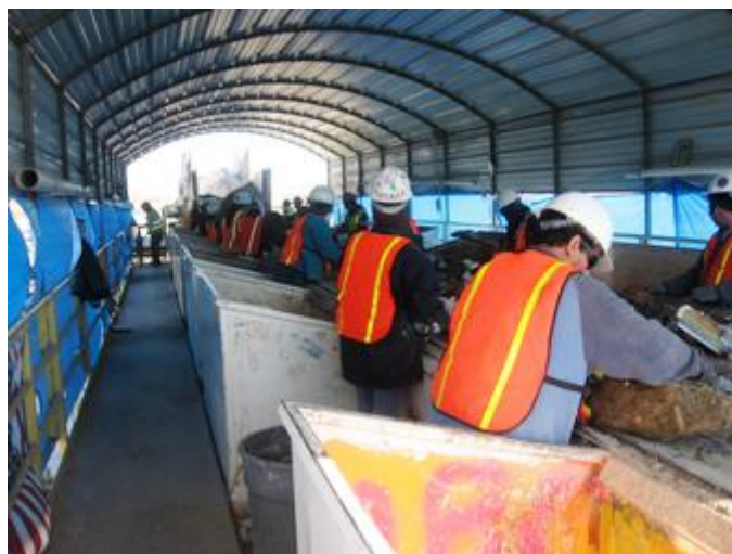
Слика 6.11. Пример једне линије за сепарацију рециклабилног отпада
