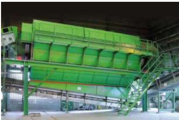
Слика 6.3. Ротационо сито за мешани комунални отпад
