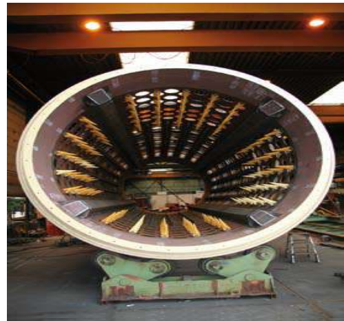
Слика 6.3. Ротационо сито за мешани комунални отпад
