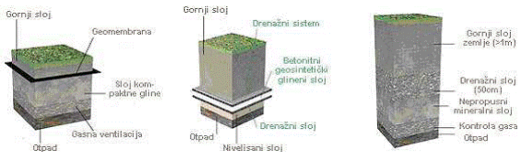
Слика 13. Приказ горњих покривних слојева депоније
