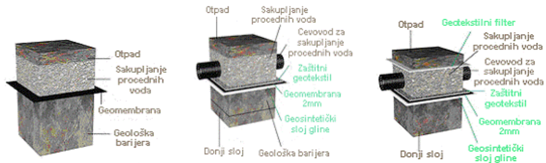
Слика 17. Приказ доњих слојева депоније
