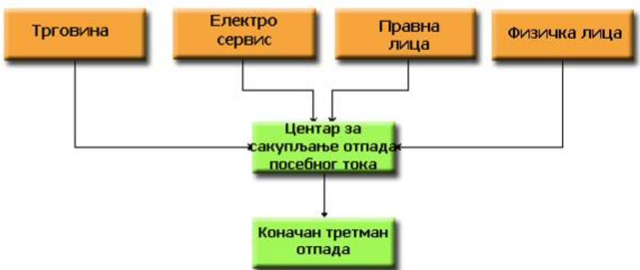
Шема 16 - Шема сакупљања отпада електронских-електричних производа
