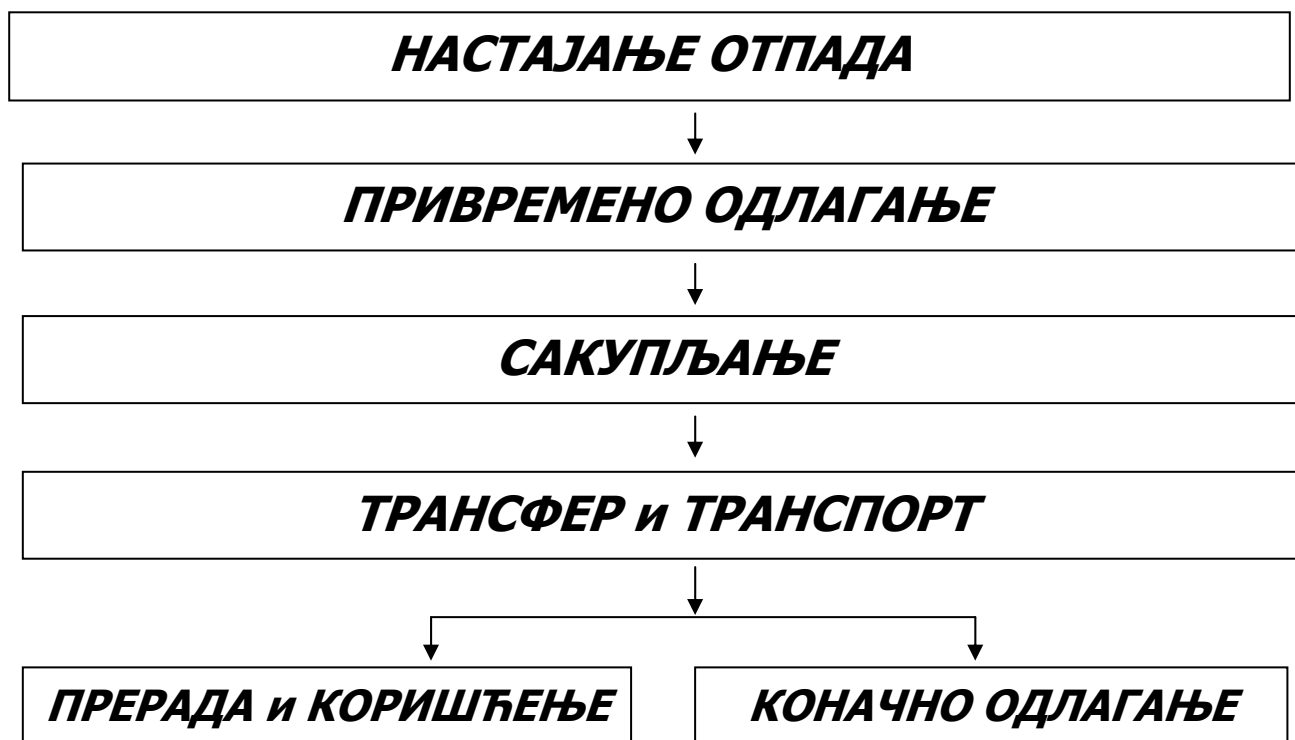
Шема 2 - Елементи интегралног система збрињавања отпада
