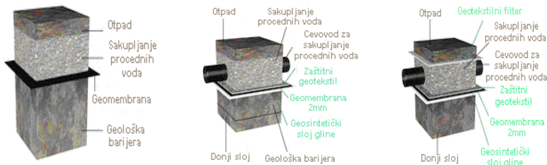
Slika 5.17 Prikaz donjih slojeva deponije
