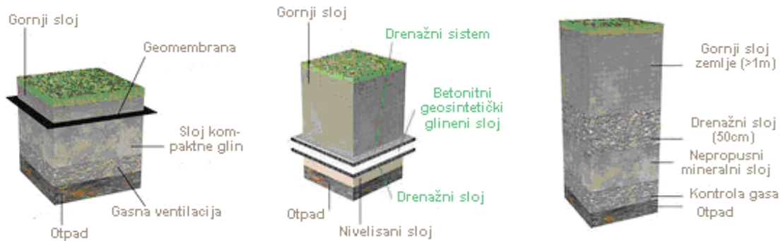
Slika 5.13 Prikaz gornjih pokrivnih slojeva deponije
