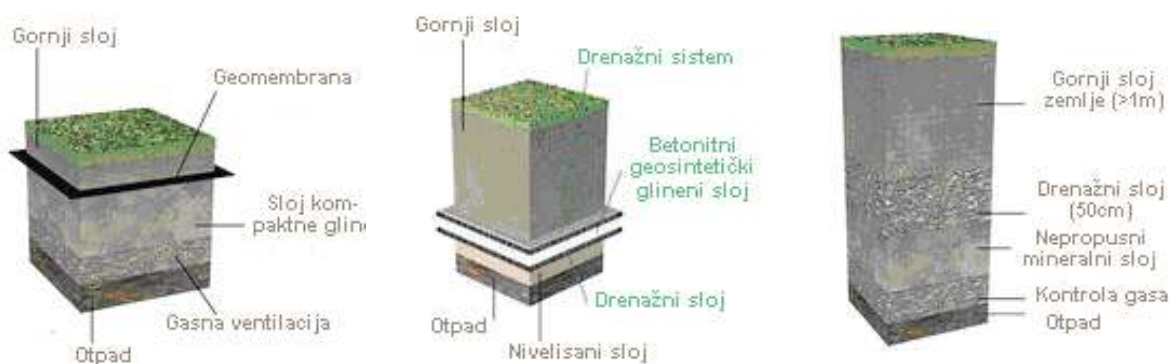
Slika 5.18. Prikaz gornjih pokrivnih slojeva deponije
