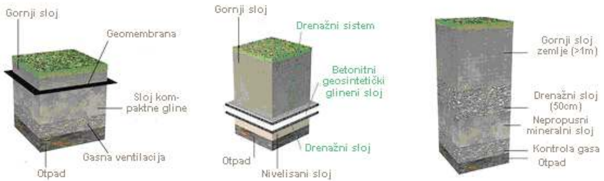
5.18. kép: A hulladéklerakó felső fedőrétegeinek bemutatása
