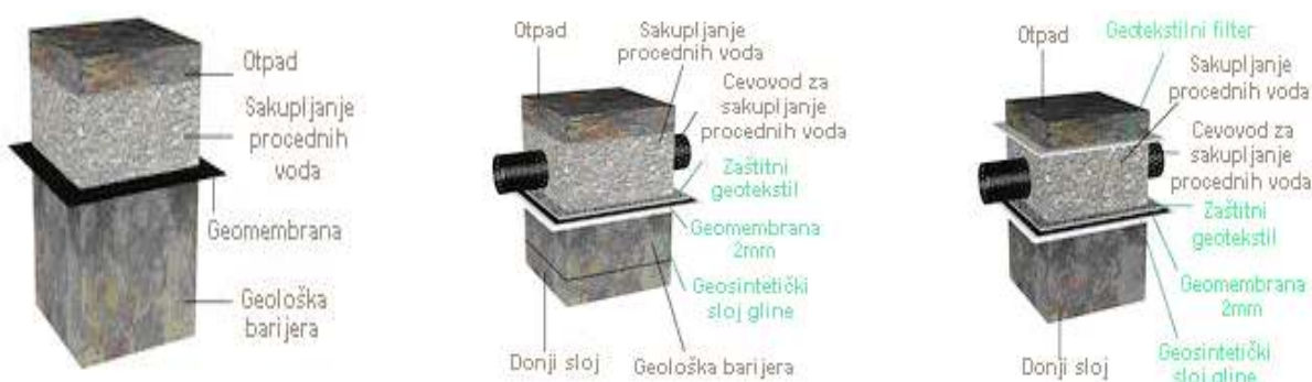
5.22. kép: A hulladéklerakó alsó rétegeinek bemutatása
