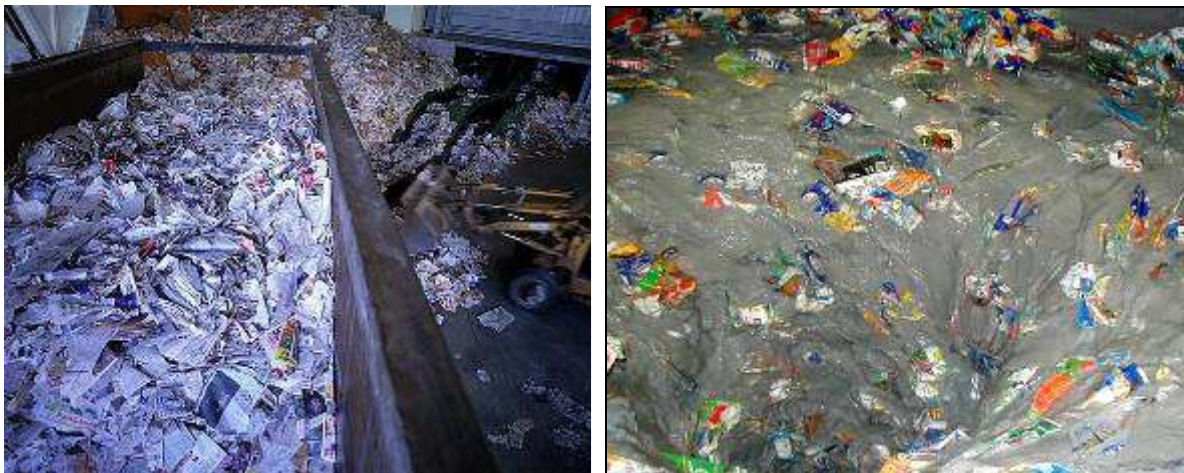
6.3. kép: A papír fogadása és mosásának folyamata
