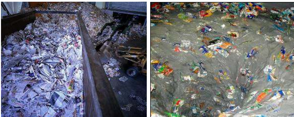
Slika 6.3. Prijem papira i proces njegovog ispiranja
