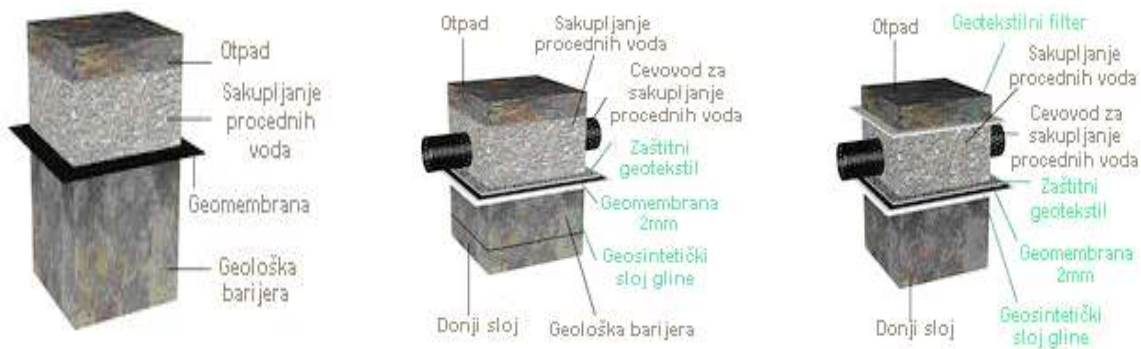
Slika 5.22. Prikaz donjih slojeva deponije
