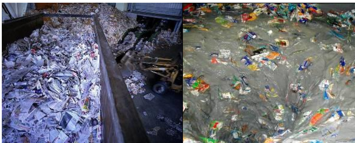
Slika 5 Prijem papira i proces njegovog ispiranja
