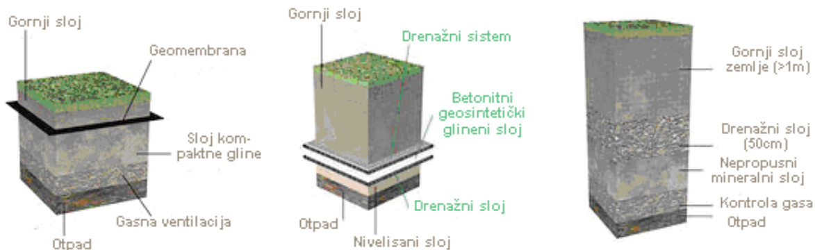
Slika 39. Prikaz gornjih pokrivnih slojeva deponije
